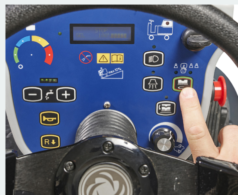
Dysk szczotki/ssawa obniża się automatycznie, co minimalizuje wysiłek operatora
